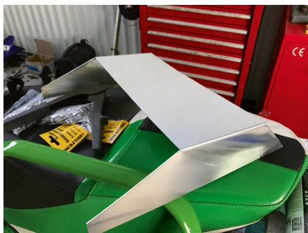
Vår lokala plåtslagare Färnäs PlåtTech AB snickrade till denna tunnelförlängning efter vår mall.
