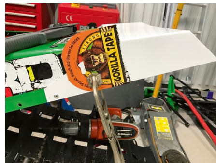
Tunnelförlängningen hålls på plats av en svetstång och nya hål borrades från insidan.
