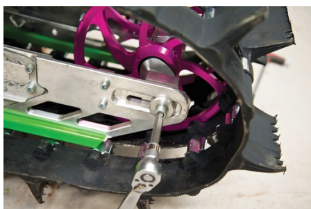
Spänn mattan efter specifikationerna. Här ser ni att förlängningen kunde ha varit c:a 2 cm längre för att ge lite mer marginal. En annan lösning är annars att vända offset-axeln så att vändhjulerna kommer längre bak.
