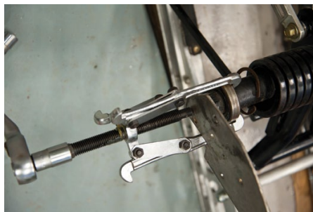
Avdragaren lyckades bra med att dra sönder lagret så att bara den inre lagerbanan blev kvar. Detta löste vi med vinkelslipen.
