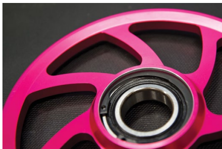
Tunnelhjulen på 7" från BilletX svarvades upp för att vi skulle kunna stoppa dit ett större lager.
