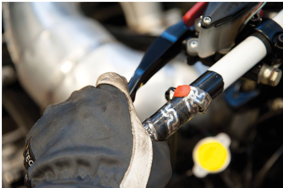
Nu ska det luftas, öppna luftnippeln på oket, tryck in bromshandtaget och lås luftnippeln. Upprepa tills bromsen verkar fungera och gärna tills det är fräsch bromsvätska som kommer ut till burken.
