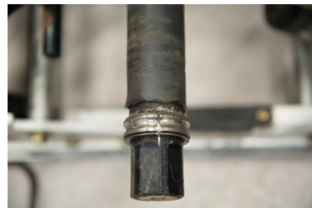
Avdragaren lyckades bra med att dra sönder lagret så att bara den inre lagerbanan blev kvar. Detta löste vi med vinkelslipen.
