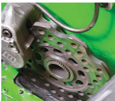
På med bromsskivan samt oket med de nya bromsklossarna, se till att skivan sitter åt rätt håll! Det missade vi...
