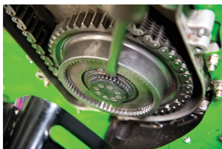
På med drev och kedja för att till slut säkra med låsringen.
