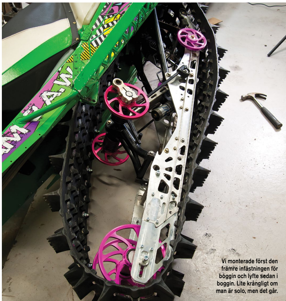
Glöm inte att stoppa dit torsionsfjäders innan ni skjuter på de nya hjulen...
