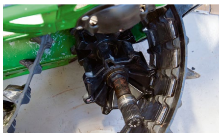
Drivaxeln ska nu gå att trycka mot bromssidan så att den ploppar ur kedjehuset och kan plockas ur.
