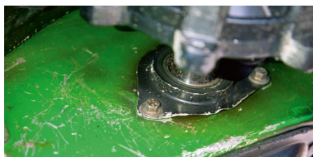
Även denna hållare för lagret som sitter lite tigt till måste skruvas loss, sitter fast i bromsoket.
