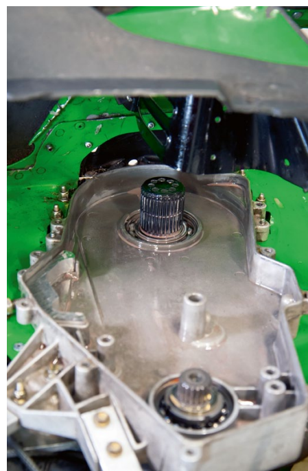
Av med locket på kedjehuset för att komma åt att ta loss dreven och kedjan.
