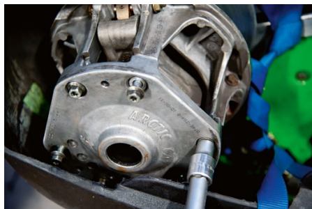
Då fjädern var av behövdes det inget tryck på locket när detta skruvades bort.
