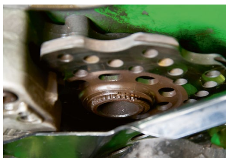
För att plocka ur drivaxeln behöver man ta loss bromsskivan som sitter med en låsring.
