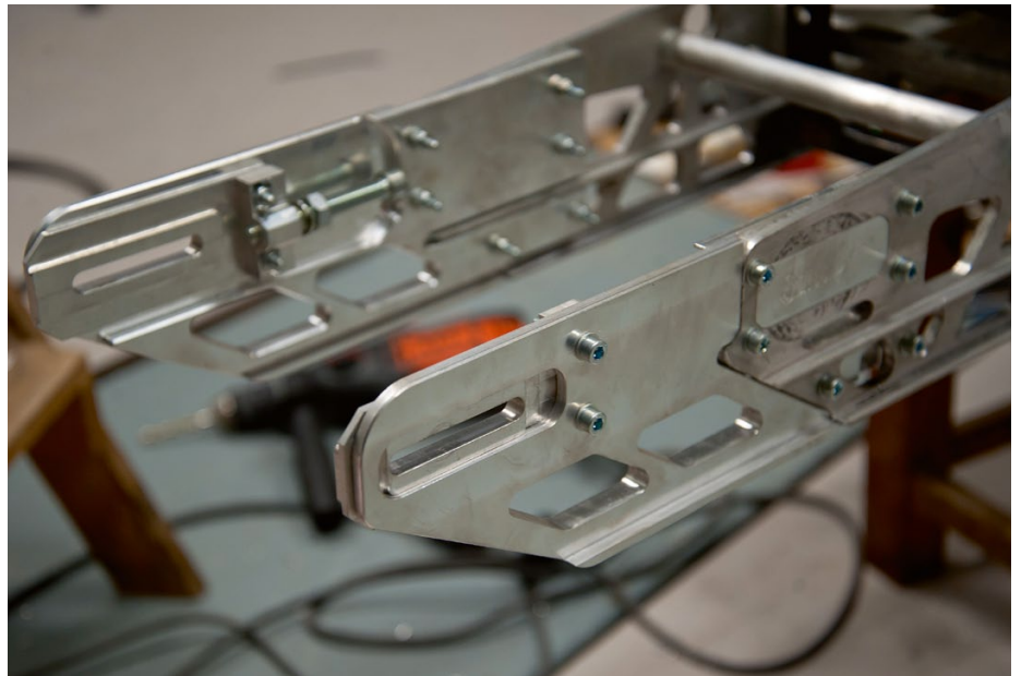
Nu sitter allt på plats och det är dags för en offset-axel så att vi kan få dit större vändhjul. Lär behöva ytterligare en förstärkningsaxel placerad närmare hjulen, då den första mest agerar som stopp för den bakre saxen.
