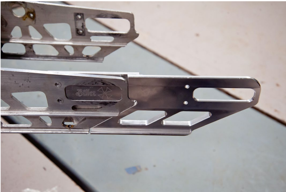
Förlängningen av boggiskenorna från BilletX förlänger nästan 20 centimeter vilket gör att vi ska kunna använda en 146 tums Challenger Extreme matta istället för originalets 128 tums S/X-matta.
