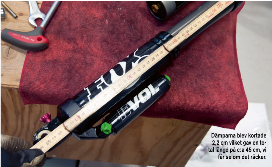
Denna kortning av dämparna gjorde det betydligt lättare att styra och det var även lättare att montera dom.
