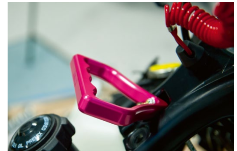
Ett nytt starthandtag som följde färgtemat införskaffades hos BilletX. Även ett dödmansgrepp monterades.
