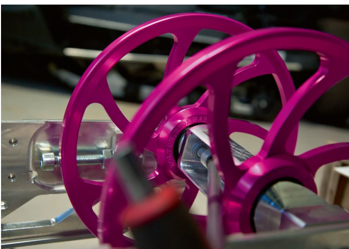
Det fick bli 9" stora Turbin-vändhjul i vackert rosa. När offset-axeln monterades insåg vi att boggiskenorna var lite krokiga.
