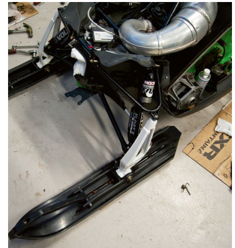
Denna kortning av dämparna gjorde det betydligt lättare att styra och det var även lättare att montera dom.
