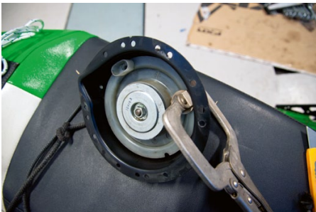
Istället för att plocka isär hela startapparaten bytte vi startsnöre på plats genom att låsa den i utdraget läge.
