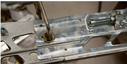
Vi lägger motsatt sidas förlängning på utsidan som bormall och håller fast den med en svetstång innan vi borrar.
