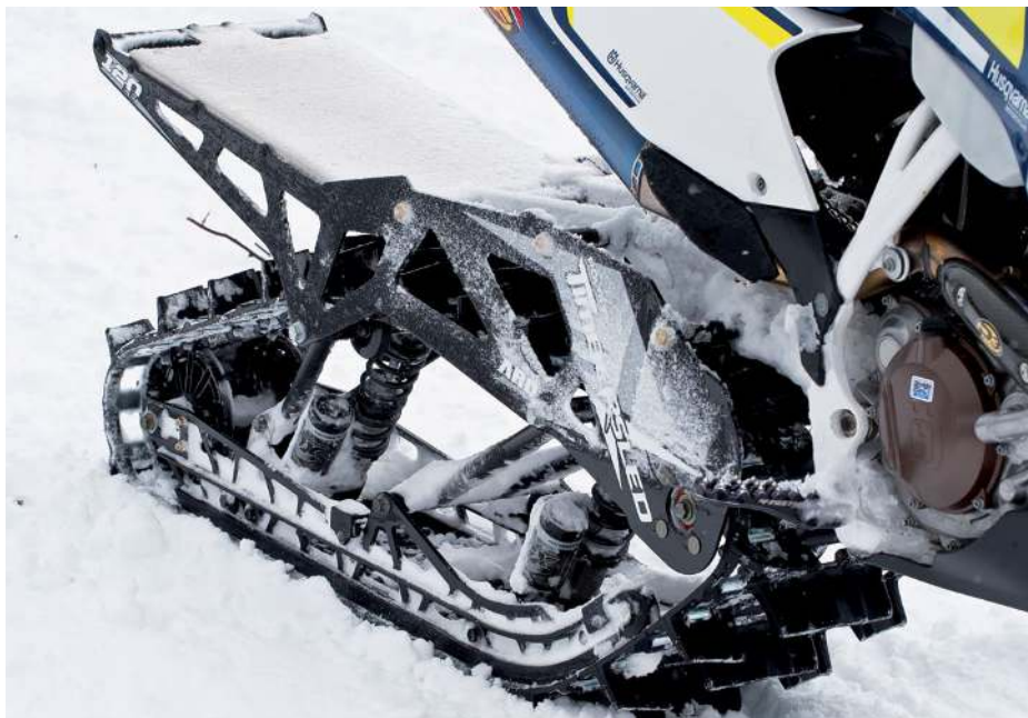
Den nya boggin är också väldigt Polarislik. Utrustad med FOX-dämpare av olika utförande beroende på modell. Mattan som också är 11,5 tum bred har en konvex utformning på kammarna som högst mäter 63,5mm.
