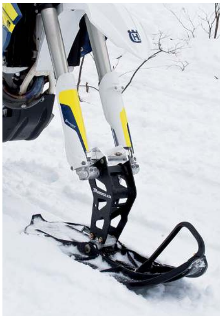
Skidloopen känner vi igen från Gripper men resten är eget. 11,5 tum bred med tre kölar och styrstål.
