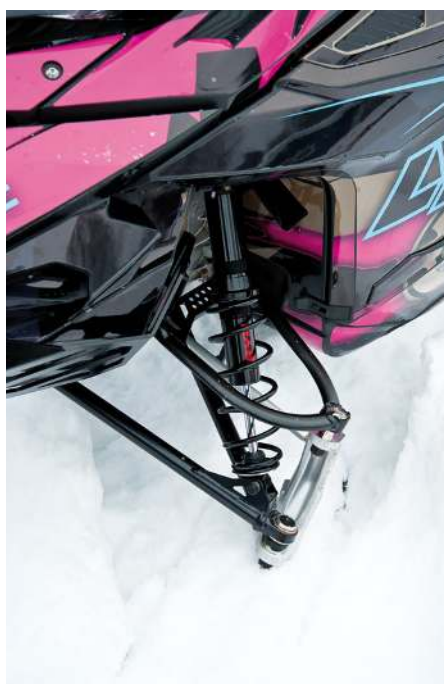
Ny Lynxen har en lättare LFS-framvagn med längre fjädringsväg och högre markfrigång.
