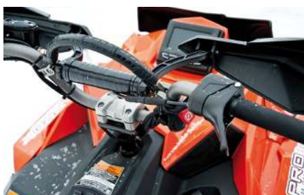
Nedflyttade reglage och en utmärkt PIDD-display i färg, handtagsskydden hade man dock kunnat skippa på den här typen av skoter.
