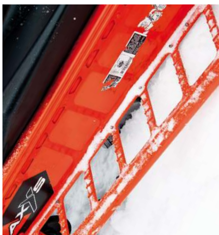
Powdertrac-fotstegen tillhör toppen fast de andra börjar efterrapa Polaris, de är stabila och rensar lätt bort snön.
