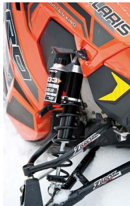
Fusk och fusk, men det sitter iallafall en smalare Zbroz-framvagn på testexemplaret.
