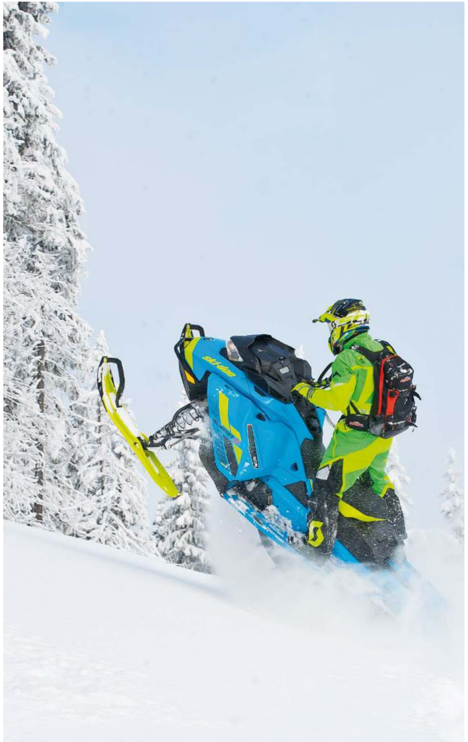
RAS 3-framvagn med mjuka HPG Plus-dämpare, har en tendens att vilja dyka ibland men gör skotern smidig bland träden.
