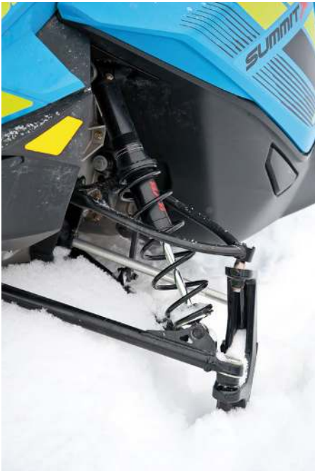
RAS 3-framvagn med mjuka HPG Plus-dämpare, har en tendens att vilja dyka ibland men gör skotern smidig bland träden.
