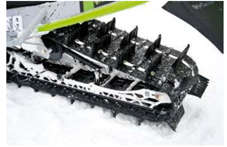
Även HardCore kör med en PowerClaw-matta med 76 mm i kamhöjd, vilket fungerar utmärkt i detta före.
