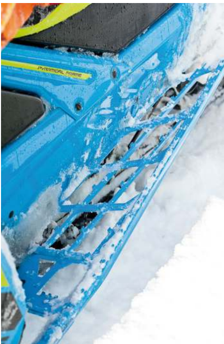
Vid dagens slut har Summiten precis som Lynxen skapat lite is längst bak på fotstegen och tunneln.
