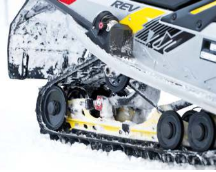
Dämparna i rMotion-boggin har hoppat upp några snäpp och är nu KYB Pro 40 med 22 komplägen.
