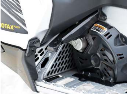
Fotpinnen för stöd uppåt sitter på plats men fotholkarna är öppna åt sidorna, finns tillbehör om man önskar stöd.
