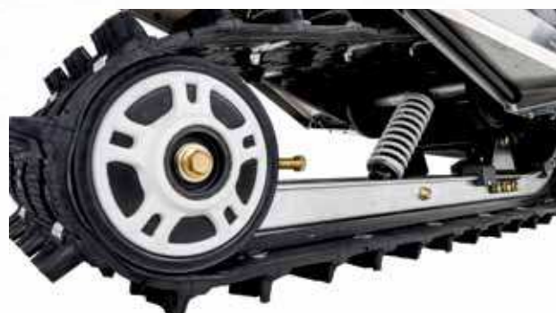
Boggin har en dämpare och två fjädrar med möjlighet att justera förspänningen.
