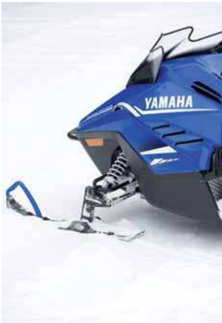
SnoScoot har en riktig framvagn med dubbla A-armar samt en för Yamaha unik skida. (Finns även som Arctic)
