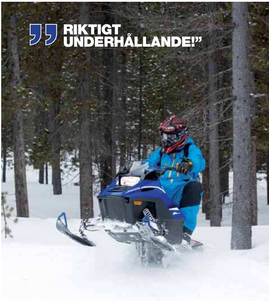
Motorn mäter 192 kubik och ger ifrån sig 9,1 hästar vid 5400 varv. Notera att avgaserna går ut framåt.
