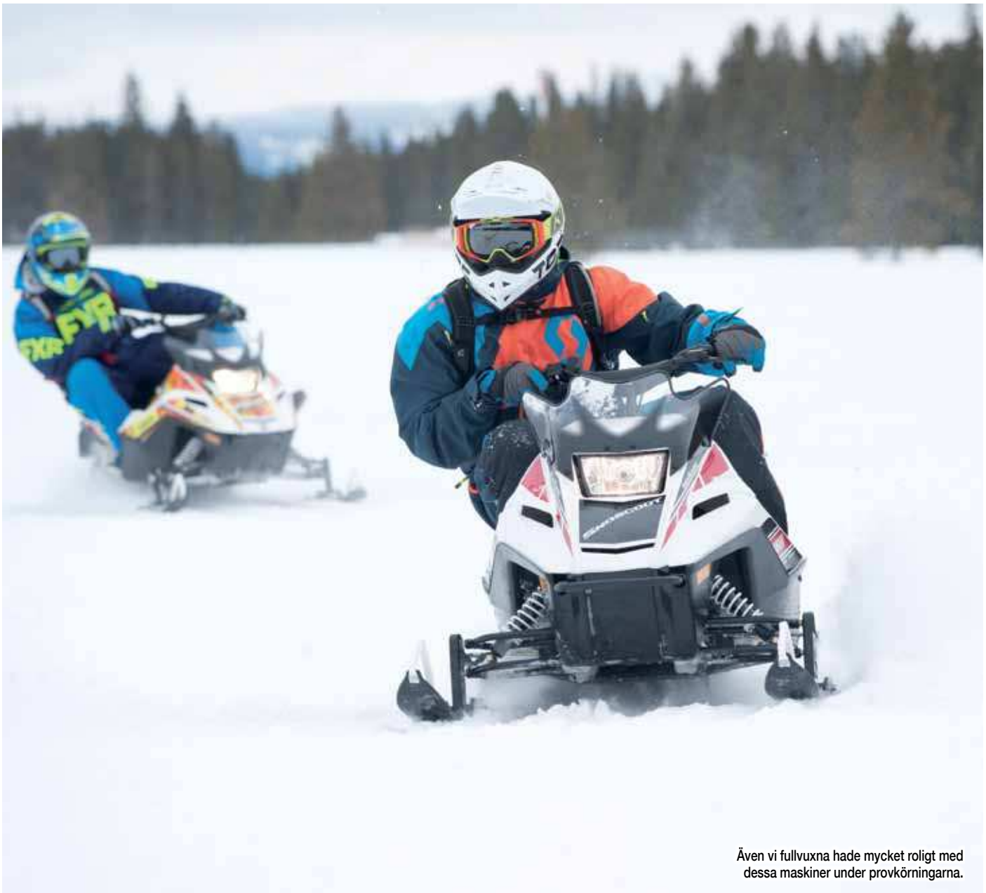
SnoScoot har en riktig framvagn med dubbla A-armar samt en för Yamaha unik skida. (Finns även som Arctic)
