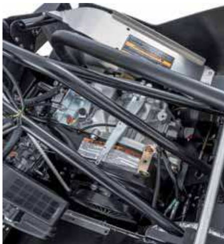
Motorn mäter 192 kubik och ger ifrån sig 9,1 hästar vid 5400 varv. Notera att avgaserna går ut framåt.
