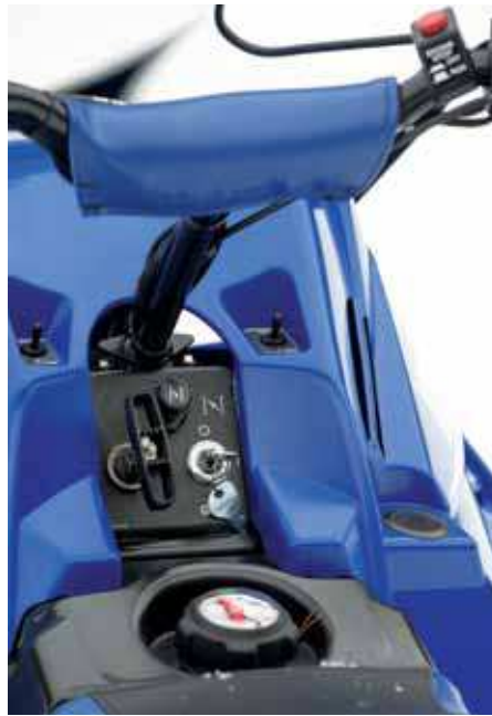
Motorn matas via en förgasare och har därför choke. Mycket lättstartad tack vare dekompression av motorn.
