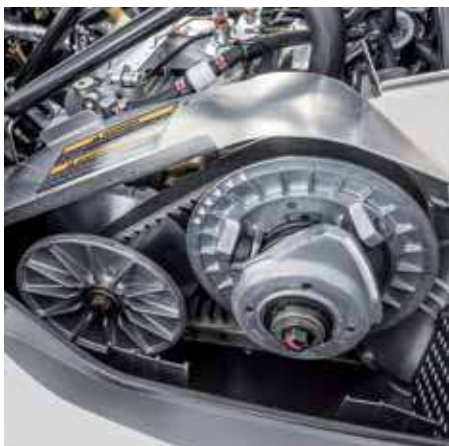
Driften sker via ett riktigt variatorsystem vidare till rem-drift av drivaxeln vidare till mattan.
