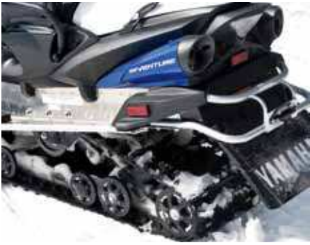
Avgaserna hittar ut där bak på klassiskt RX1-manér. Boggin har flip-up funktion som underlättar backning.
