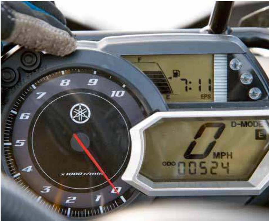
Genom att trycka på MODE-knappen väljer man mellan de tre körlägena.
