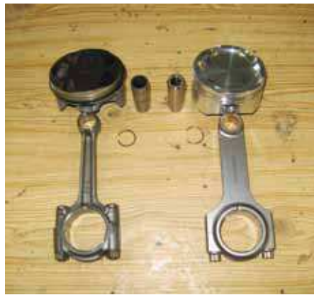
Apex standard vevstake och kolv till vänster och Carrillo stake J&amp;E-kolv till vänster.
