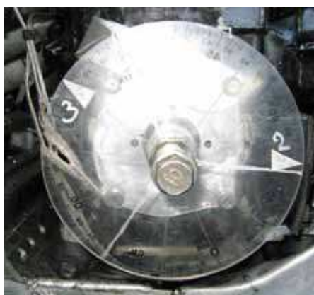
Rogers vevaxel är lite vriden 1.2.3 ska delas jämnt på 180 grader, kolla 2cyl är nästan lika!
