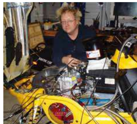
Här håller jag på att montera ett lustgassystem på Johan Rydströms Renegade 800.
