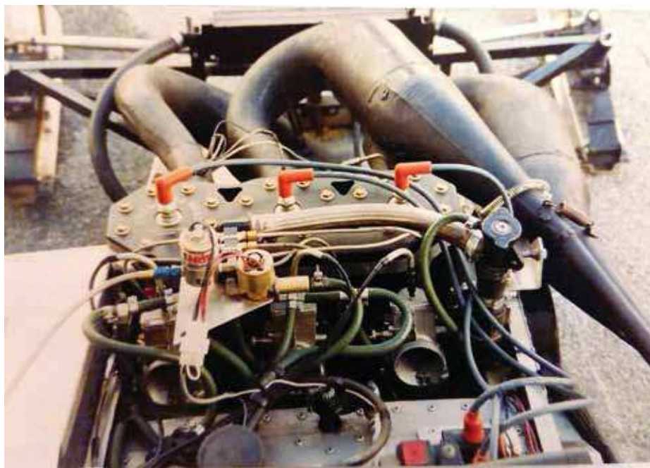
Storgripen med 1050-motorn med dom stora Pro Shoot-solenoiderna och Tikka Race Head billett-toppen. Rätt grym sak!
