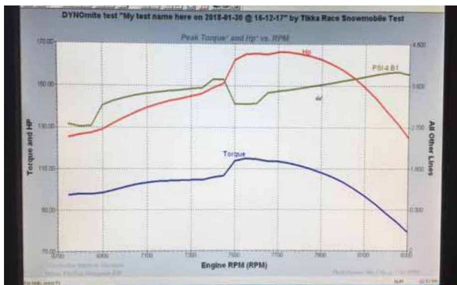
Kolla här på skärmen av en av körningarna med PPC-dämparen hur trycket ligger genom registret. Man ser ett hopp där RAVE-avgasportarna öppnar. Dom verkar inte öppna på ett speciellt varvtal som Arctic Cat och Yamaha utan ECU:n verkar bestämma när motorn behöver mer avgasdURATION.
