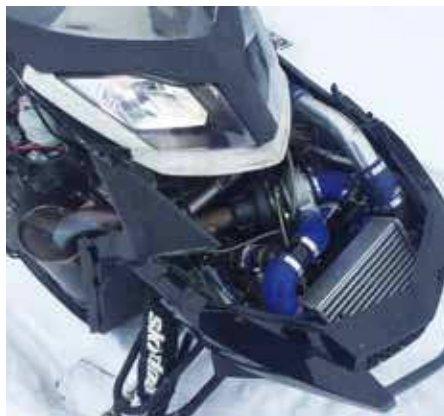
Hela paketet med dumpventilen monterad.
