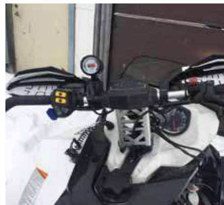
Kaltr för provkörning med bredbandlambdan monterad.
