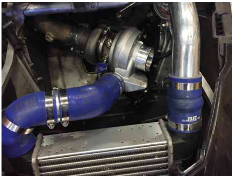
Här sitter Mitsu/Kinugawa-turbon på plats utan dumpventil.
