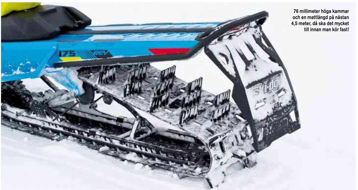
Summitens fotsteg är i toppklass, de är styva och greppvänliga samtidigt som de håller sig fria från snö i praktiskt taget alla förhållanden.
