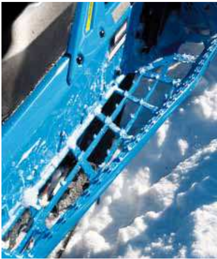
Summitens fotsteg är i toppklass, de är styva och greppvänliga samtidigt som de håller sig fria från snö i praktiskt taget alla förhållanden.
