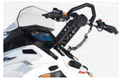
Precis som på SP får man det raka styret med den bredare burkremmen.
