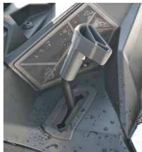
Alpha transmission heter den nya växellådan som har hög-, låg-, neutral- och backväxel.
