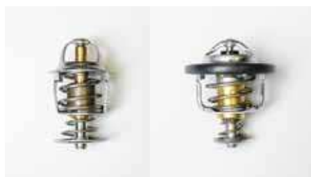
Den nya termostaten till höger sänker arbetstemperaturen från 51,6° till 43,3° och ökar flödet med 12%.
