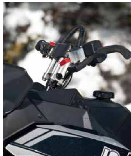
Burkrem sitter standard precis som en 89 millimeter hög styrhöjare, vilket känns lagom.
