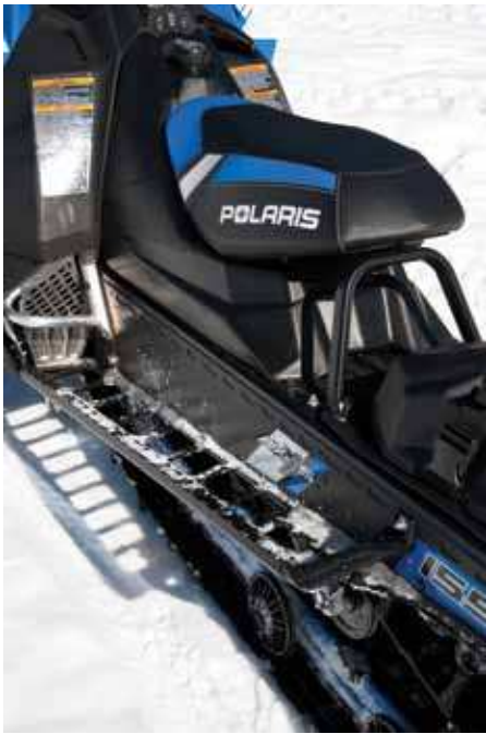
Den nya varianten av Polaris Powdertrac-fotbrädor har större öppningar på den bakre delen av fotsteget.
