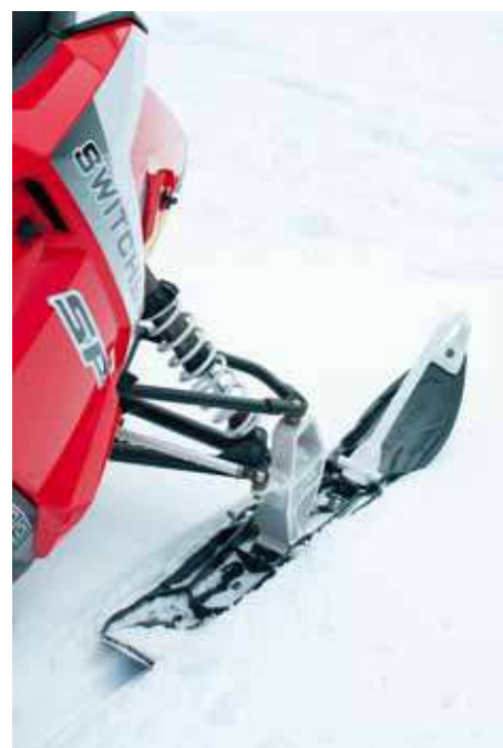
Det sitter FOX-dämpare runt om på Switchback SP. Hos oss kommer det att vara Gripper-skidor på maskinerna.
