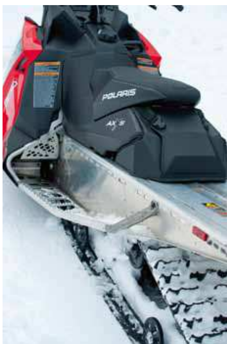
Notera vinkeln på Powdertrac Hybrid-fotstegen och dessutom är de lite bredare fram.
