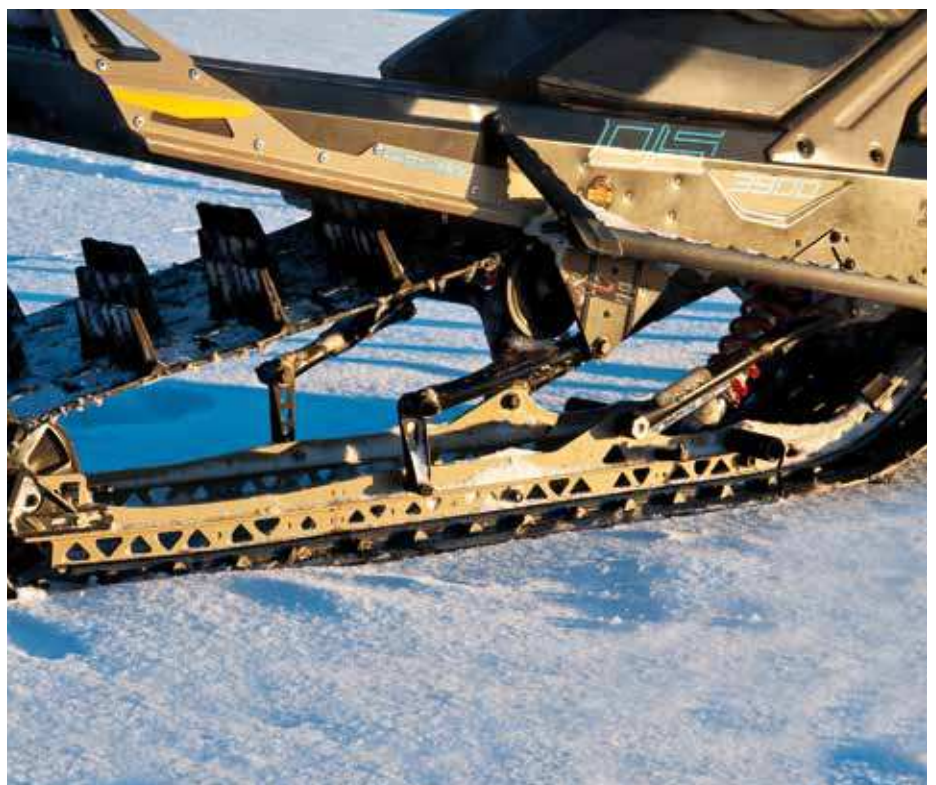
Både främre och bakre saxen har nu monterats på utsidan av boggiskenorna för att minimera snöuppbyggnaden.
