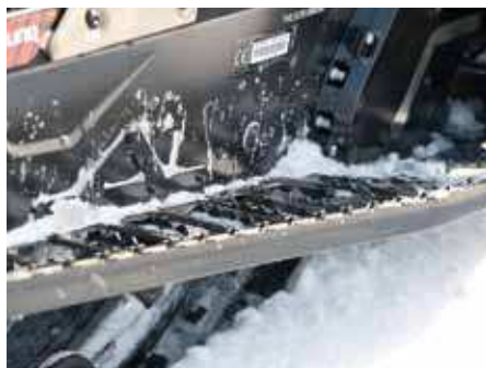
Fotstegen klarar sig bra mot snö- och isuppbbyggnad.
