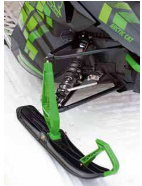
I framvagnen på ZR 8000 SP hittar vi nya Fox 1.5 Zero RC coilover-dämpare med justerbar kompression och retur.
