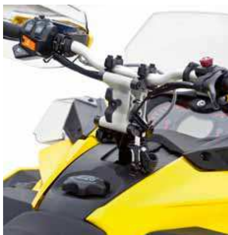
Styrhjäjaren på MXZ går att skjuta framåt och bakåt hela 10 centimeter i fyra fasta positioner.
