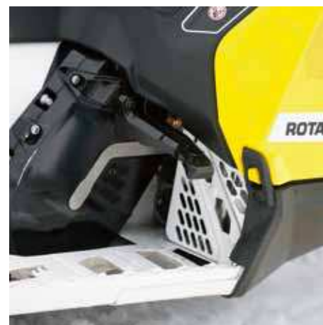
MXZ har öppna fotholkar åt sidan vilket verkligen kräver tillvänjning, alternativt att man köper till ett stopp.
