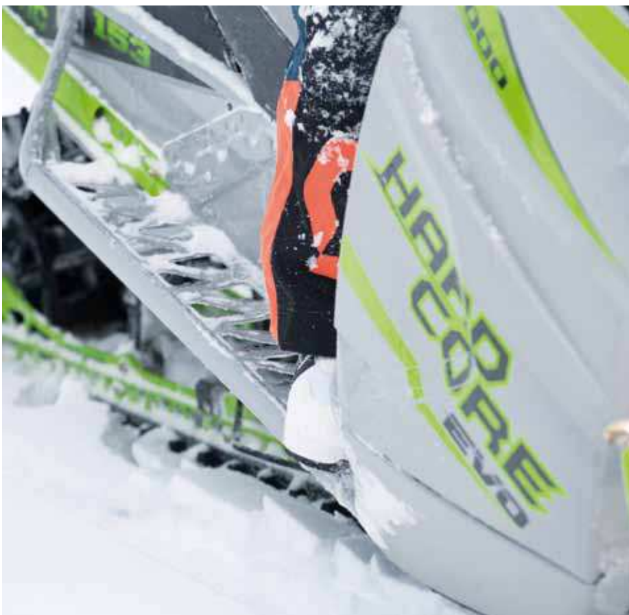
Hardcorens fotsteg är smala och tillåter att man kliver långt fram, vi hade dock gärna sett en ännu aggressivare variant med bättre grepp och snögenomsläpp.
