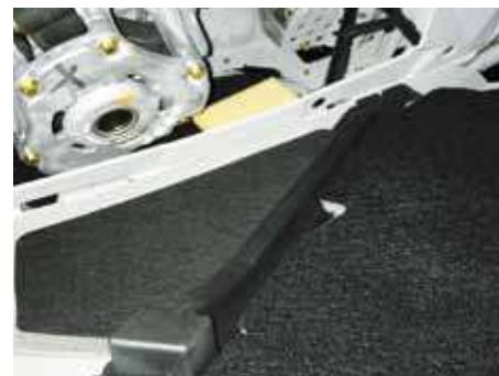
De lite mer åtsittande kåporna lämnar lite spelrum till variatorerna vilket ska avhjälpas med en förstärkning.
