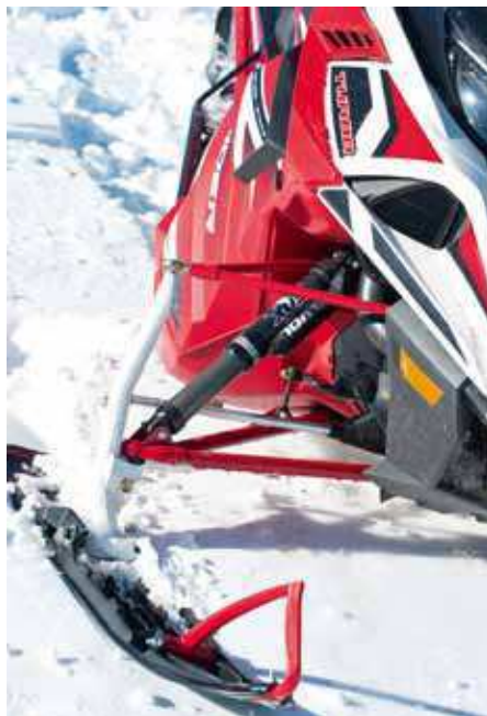
XT-X Le har den lättare SRV M-framvagnen och till i år har Yamaha utvecklat helt egna skidor med 6" bredd.
