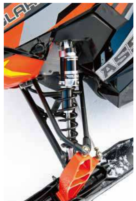
Tack vare Walker Evans-dämparna med justerbar kompression runt om kan man snabbt ändra köregenskaperna.
