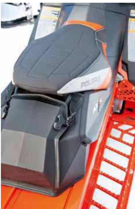
Sportdyna som smalnar av fram mot tanken fungerar faktiskt över förväntan även för friåkning. Det finns även ett bra förvaringsfack under dynan.
