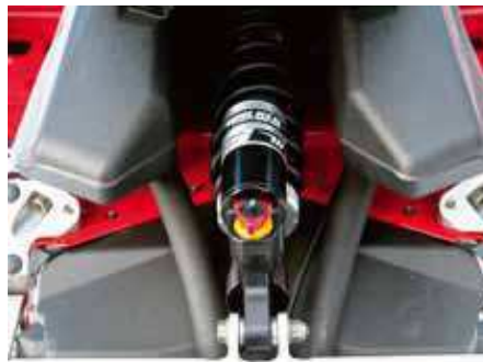
Snacka om lättjusterad boggi! Lika bra dämpare här som i framvagnen, schimsade för cross-country.
