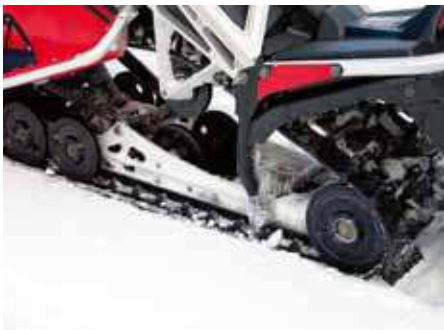
Närmast snön har man på XCR en kort Back Country-matta med 44mm kammar, perfekt för ändamålet.
