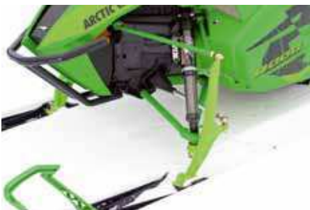
Den gröna faran har AMS Bone 36" framvagnen bestyckad med luftdämpare från FOX.
