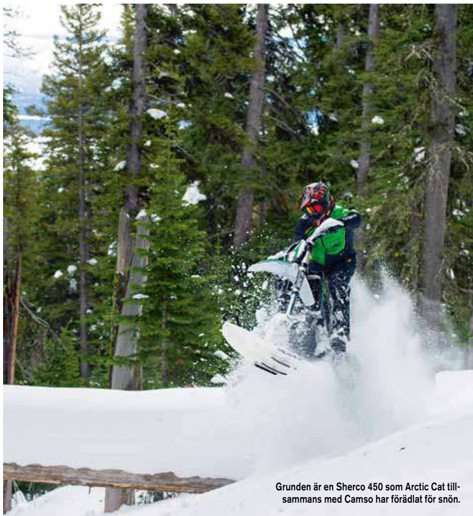
Den breda skidan har dubbla styrstål och även en typ av stål i ytterkanterna.
