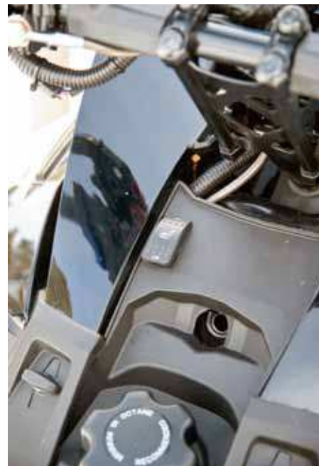
Nere till vänster ser man en av de vridfästen som finns till huv och kåpor. Man har även tillgång till värme i rumpan.
