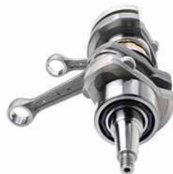
En av många saker som skiljer 800 H.O. från föregångaren är den lättade vevaxeln från crossmaskinen.
