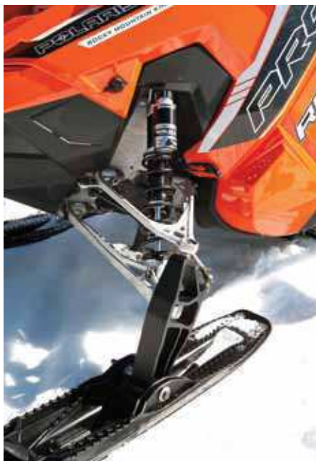
Smidda A-armar i aluminium och en högre spindel är några av förändringarna i framvagnen på Pro-RMK.
