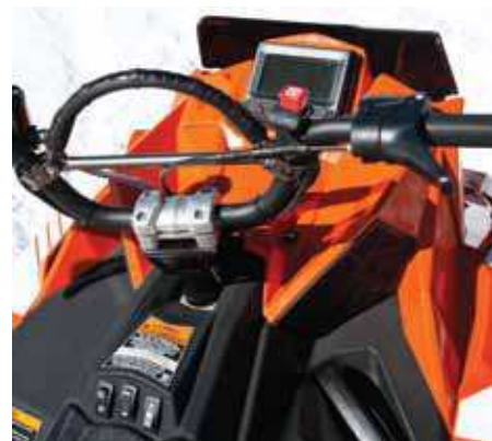
RMK-modellerna har både ett högt och ett lågt ProTaper-styre, standard på 163:an är ett högt.
