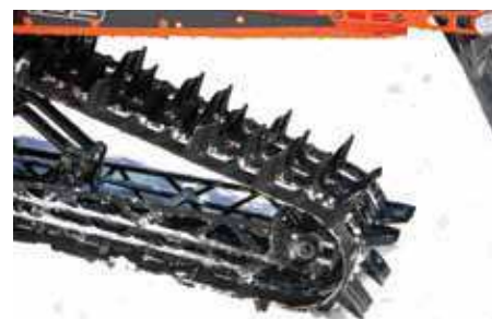
Dataprogrammet hade först ritat betydligt tunnare boggisenor som ändå skulle hålla, men både vi och Polaris tyckte uppenbarligen att detta räckte när det gällde att banta.
